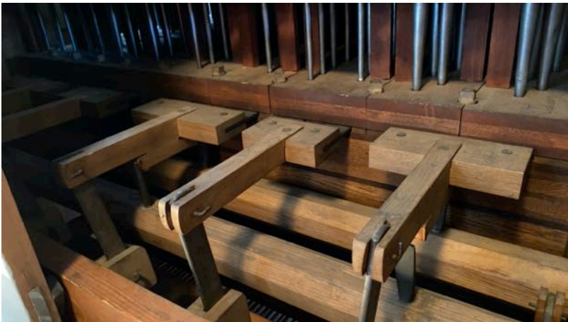
Osa urkujen listeistä kytkettyinä rekisteritappeihin. En del av orgelns slejfer som är kopplade till registerandragen.
